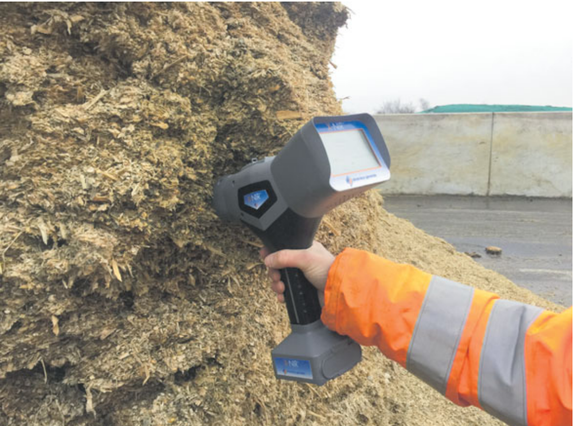
Fóðrið metið með einföldu NIR-tæki (Near Infrared Reflectance).
