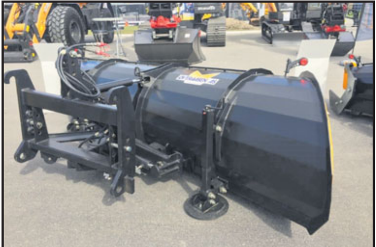
Överaasen DLS-270 skekkanleg kastönn fyrir dráttarvél og hjólaskóflu
