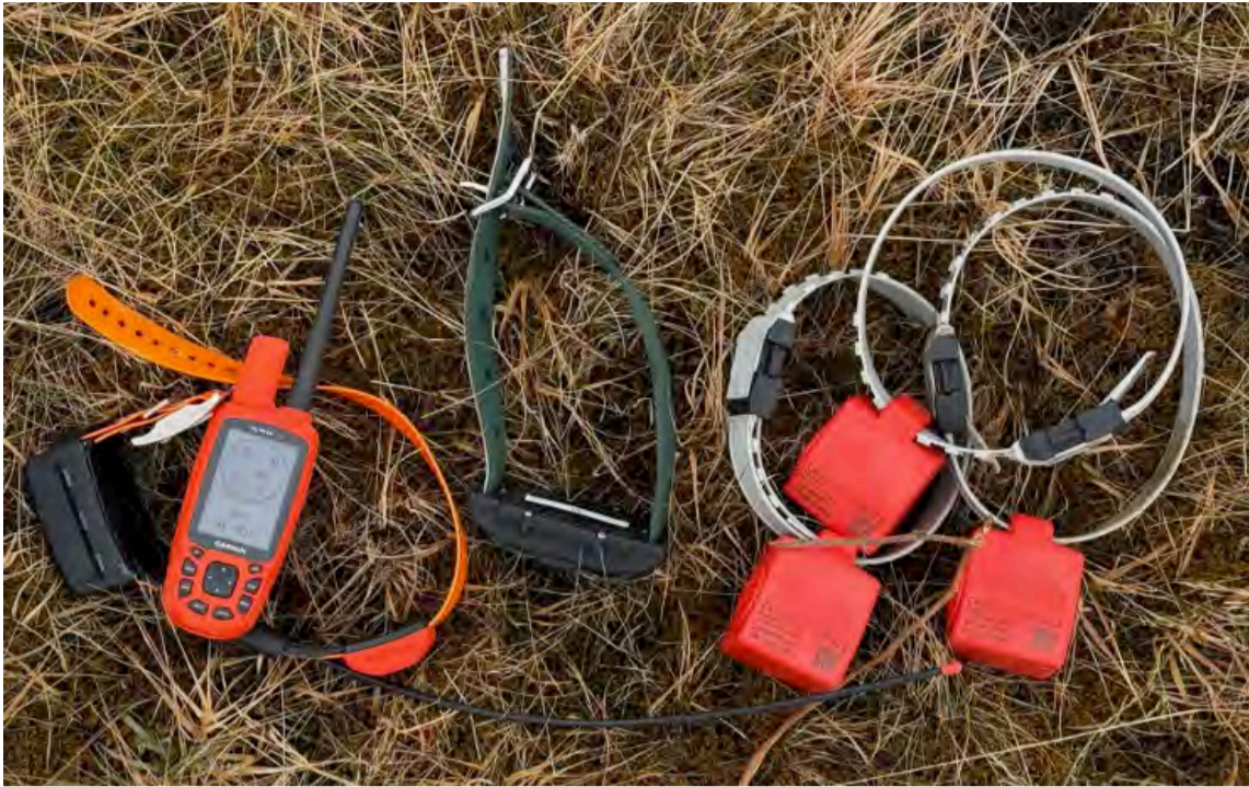
Mynd 1 – GPS tækin sem voru notuð í prófuninni. Frá vinstri: Garmin Alpha 50 handtæki og hundaól, tæki frá Félagsbúinu Sandfellshaga (svart með grænni ól), og þrjú Model Red tæki frá findmy í Noregi.
