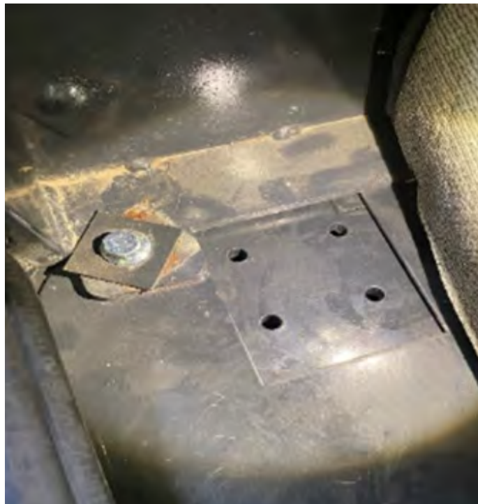
Hér er einn bolti og örpunn skinna sem halda öryggishúsinu á vélinni. Viðkomandi vél var hönnuð fyrir veltigrind og sjást götin fyrir hana við hliðina. Húsið hefur ekki verið hannað með þessa vél í huga.
