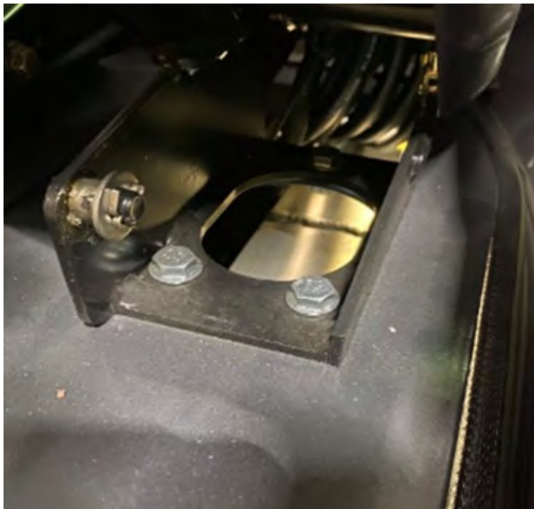
Hér er opið beint niður úr stýrishúsi að mótör og greið leið fyrir þústmengun inn í öikumannshús. Á þessari vél var ekkert loftinntak með síum fyrir stýrishús til að tryggja ferskt loft fyrir öikumann.
