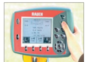
Quantron A - Magnstýritölva. Tryggir nákvæma magndreifingu.
