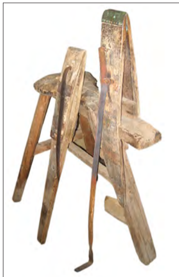
Saumhestur, ásamt klemmu í sama skyni, úr vinnustofu nemenda á Hvanneyri; til mikils hagræðis við leðursum og aðra leðurvinnu vegna aktygjasmíði.
