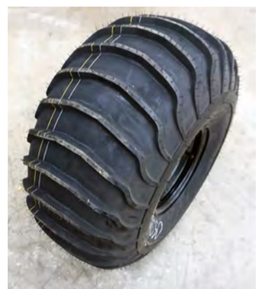
Dekkin eru eins og skófludekk fyrir sand, en ætluð til að komast vel áfram í vatni.
