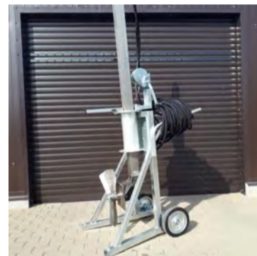
Glussadrifnar gólfhræur. Vinnudýpt- 1,9 m. Stærð á skrúfu- 48 cm. Rotor- 12 kw. Glussaflæði- 75 L/mín. 20 m af glussaslöngum fylgja. Mesta hæð frá gólfi- 2 m. Burðarvirki - heitgalf / ss stál. Hákonarson ehf. S. 892-4163. Netfang- hak@hak.is
