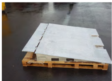
Rampar fyrir frysti/kæligáma á lager. Burðargeta 10 tonn. Dekkplata 10 mm, L- 170 cm x B- 200 cm x hæð- 21 cm. Heitgalvaniserað stál. Lyftaratækur á þrjá vegu. Eigum einnig rampa fyrir hefðbundna sjógáma. Hákonarson ehf. S. 892-4163 www.hak.is hak@hak.is
