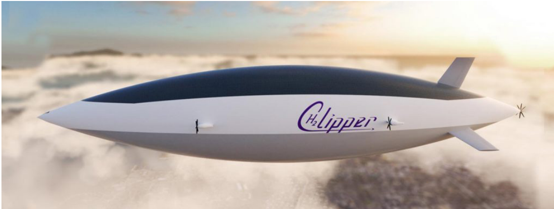
H 2 Clipper loftskipið fær lyftigetuna af vetni og mun vetni líka verða notað til að búa til rafmagn með efnarafólum fyrir rafmótora sem knýja hreyfla loftfarsins.
