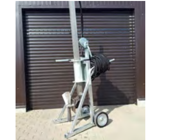
Glussadrifnar gólfhrætur.Vinnudýpt- 1,9 m. Stærð á skrófu- 48 cm. Rotor- 12 kW. Glussaflæði- 75 L/mín. 20 m af glussaslöngum fylgja. Mesta hæð frá gólfi- 2 m. Burðarvirki- Heitgalf / SS stál. Hákonarson ehf. S. 892-4163. Netfang: hak@hak.is
