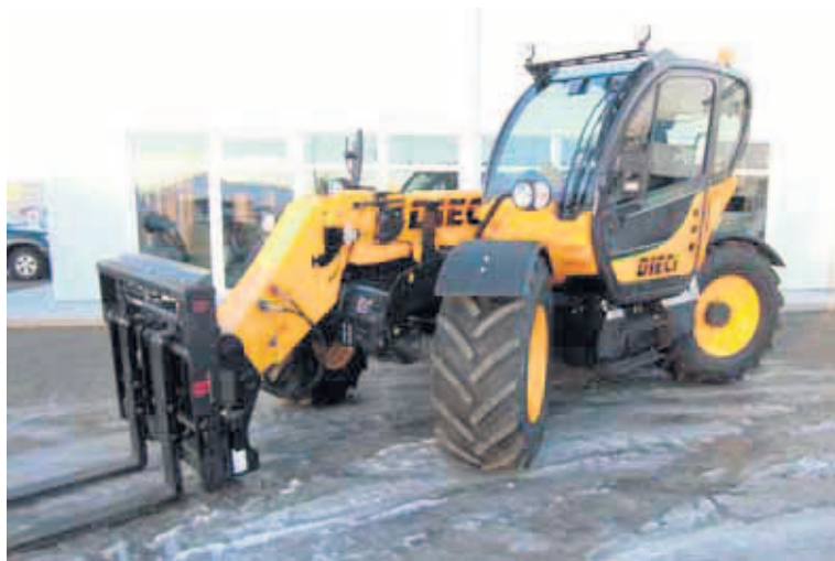
Hægt er að beygja bæði með fram- og afturhjólum, sem er stór kostur.
