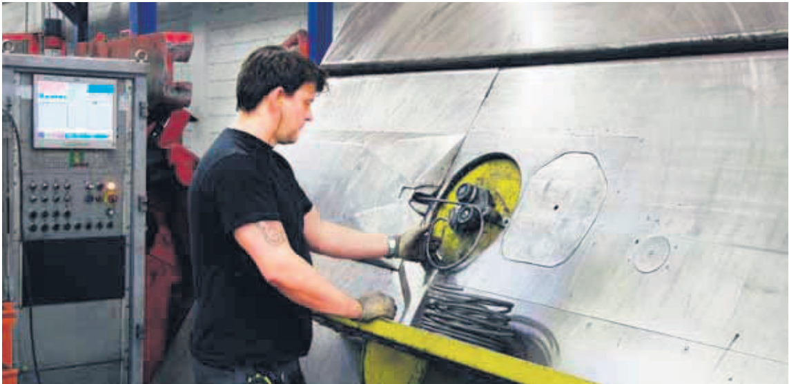
Kristján Guðmundsson var að vinna við tölvustýrðu kambstálvélina. Þar er hægt að beygja stál af mikilli nákvæmni og flóknum útfærslum en vélin getur líka afkastað einfaldari lykkjum úr tveim til þrem tonnum á dag.
