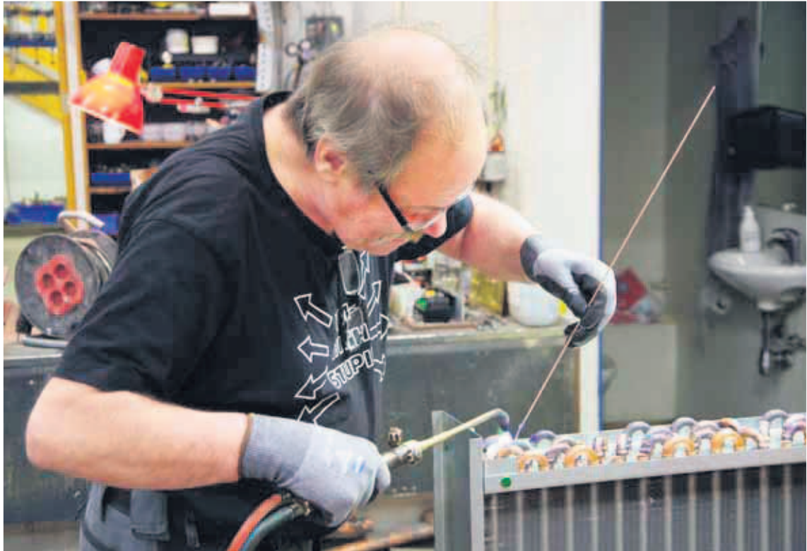
Örn Óskarsson sem var að logsjóða kæli element. Hann þykir mikill listasmiður og er með mikla reynslu að baki. Hann hefur líka víða starfað í gegnum tíðina, meðal annars sem sprengjusérfræðingur hjá sænska hernum. Örn vilar til dæmis ekki fyrir sér að redda vatnskössum í fornar dráttarvélar sem hvergi er hægt að finna varahluti í lengur.
