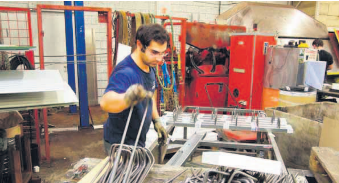
Kristján Guðmundsson var að vinna við tölvustýrðu kambstálvélina. Þar er hægt að beygja stál af mikilli nákvæmni og flóknum útfærslum en vélin getur líka afkastað einfaldari lykkjum úr tveim til þrem tonnum á dag.
