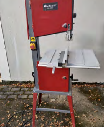
Bandsög - Einhell RT-SB 305 U (lítið notuð) Power 750W. Tro 300 mm. Sawband 2240x17 mm. Saw band speet 370 m/mín-800 m/mín (2 hraðar). Max cutting height 45° 90 mm. Max cutting height 90° 170 mm. Working table 520x400 mm. Table tiltable 0°-45° Verðhugmynd kr. 130.000. Tilboð og upplýsingar - arni0535@gmail.com .
