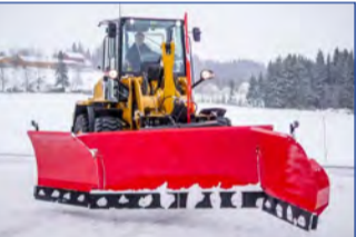
U-plógur UT 490. Hægt að skekkja til hliðar og vængi fram og aftur. 262-490cm Verð: 2.950.000 kr. + vsk
