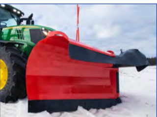
Fjölplógar VT320, VT380 Vinnslubreiddir frá: 258 til 380 cm. Sterkir plógar fáanlegir með flotgrind fyrir mikinn hraða. Verð frá: 2.000.000 kr + vsk
