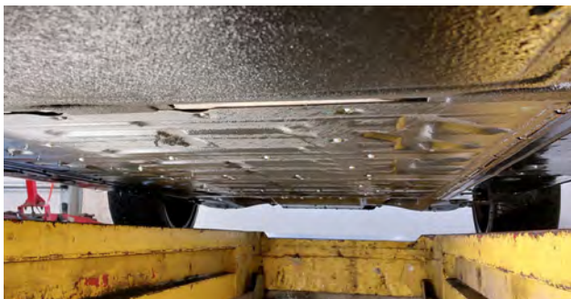
Botninn algjörlega flatur, en á möl heyrir aðeins í steinum skjótast í plötuna sem ver rafhlöðuna.
