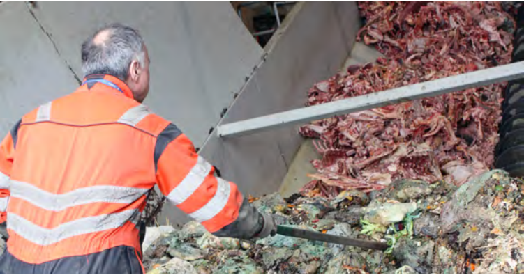
Lífræni úrgangurinn fer í gegnum hakkavél og blandast í framhaldinu við stoðefni, sem er að langmestu leyti timburkurl úr úrgangstimbri sem fellur til í Eyjafirði. Auk timburkurls er pappír úr grænnargámum á Akureyri blandað saman við og er tætt á staðnum. Mynd / MBP
