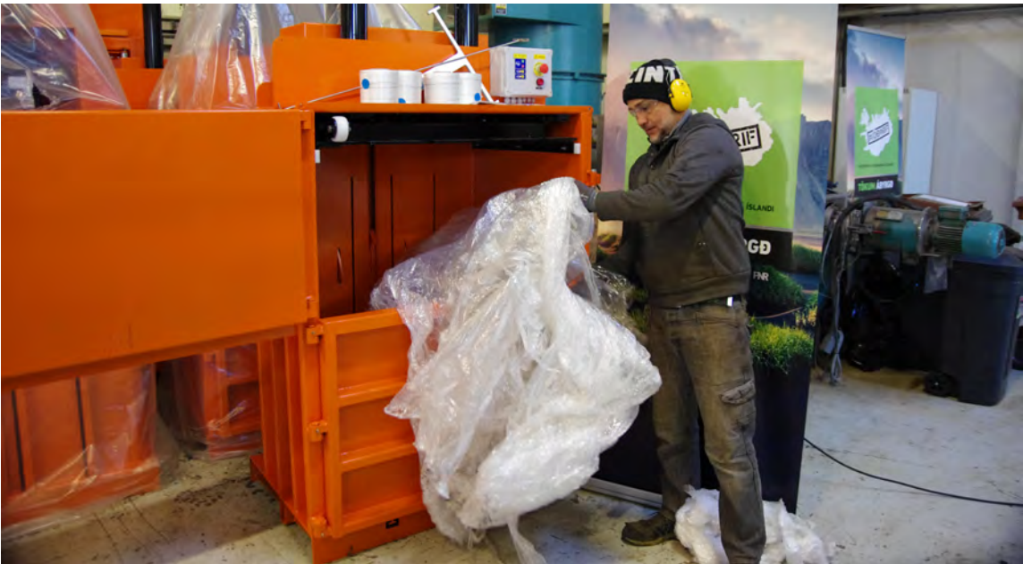
Rafknúin baggapressa sem Pure North Recycling býður bændum og öðrum til kaups til að bagga og minnka umfang á plasti fyrir flutning til endurvinnslu. Mynd / HKr.
