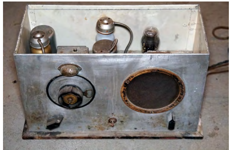
Útvarpstækið VESTRI var líka framleitt fyrir skip og smíðuð 200 slík tæki. Þau tæki voru í málmkassa á meðan hin voru í trékösum.
