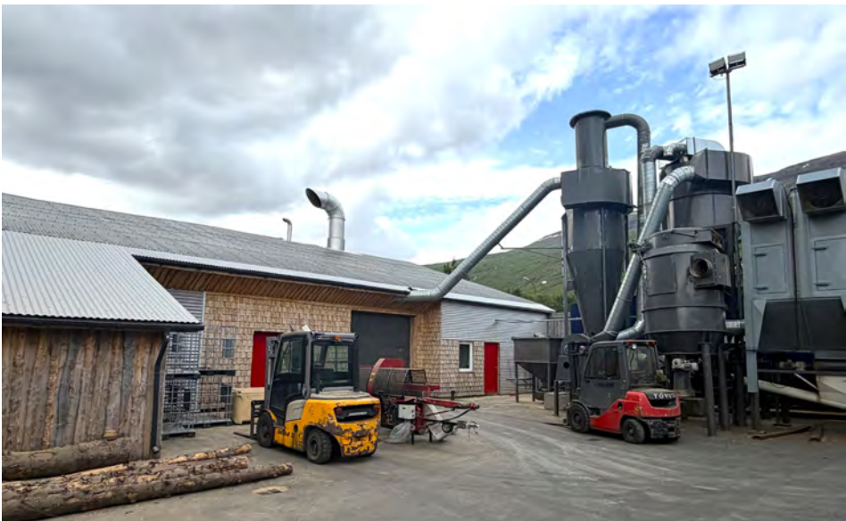
Sagi er dælt úr síló og inn í verksmiðjuna þar sem því er þjappað í viðarperlur.
