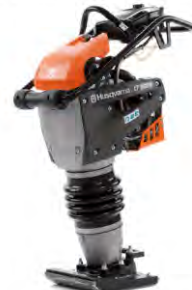
Húsquvarna Rammer Hoppari LT6005 bensín 230mm plata, 69kg
