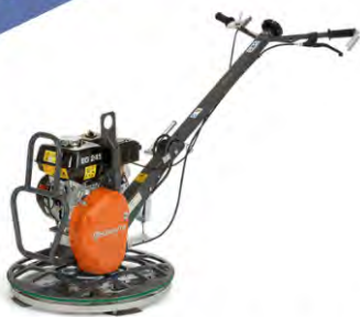
Húsquvarna Trowel BG 245 Slípivél, vinnslubreidd 60 cm
