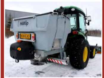
Hilltip Icestriker 600 TR Rafdrifinn kastdreifari fyrir dráttarvélar m/öflugum efnisskömmtunarbúnaði.
