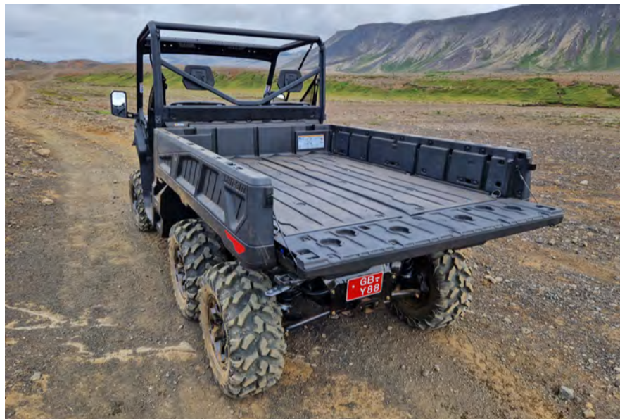
Pallurinn á Traxter 6x6 er með svipuð mál og amerískir pallbílur og má bera 771 kílógramm.
