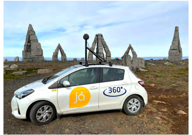
Hér er verið að mynda um Heimskautagerðið á Raufarhöfn. Sérstakur hugbúnaður er notaður í bílnum og á bílnum er áföst 360° Ladybug5 myndavél. Ladybug5 er samansett af sex myndavélum sem taka myndir hver frá sínu sjónarhorni. Hver myndavél er 5 megapíxlar og myndirnar eru því 30 megapíxlar. Öll myndagögnin eru með GPS hnítum sem eru tengd við kortavef Já.is. Mynd / Aðsænd
