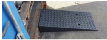
Gúmmírampar fyrir brettatjokka. Stærð- L 100 cm x B 50 cm x H 16 cm. Þyngd- 21 kg. Passa fyrir venjulega vörugama. Burðargeta- 10 tonn Hákonarson ehf. S. 892-4163, hak@hak.is, www.hak.is.
