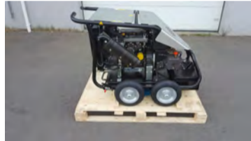
Stór og öflug háþrýstidæla fyrir verktaka til sölu. Dælan er ný og ónotuð, FDX Xtreme XL, www.comet-spa.com. Dælan er 16 L / min og max þrýstingur er 520 Bar. Vél- 26 hestöfl, Kohler dísel, KDW 1003. Vélin er vatnskæld og með rafstarti. Hákonarson ehf. S. 892-4163, e-mail hak@hak.is
