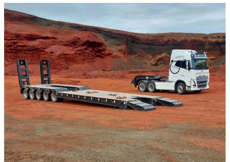
Laushálsavagninn er nýjung. Hægt er að taka frampartinn af og keyra vinnuvélar upp að framan og aftan.
