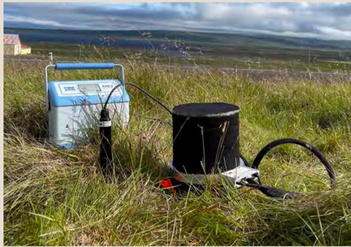
Myndirnar sýna tækin sem eru notuð við mælingarnar. Efri myndin sýnir glæra mæliklefan og á þeirri neðri er sami mæliklefi með hulu.
