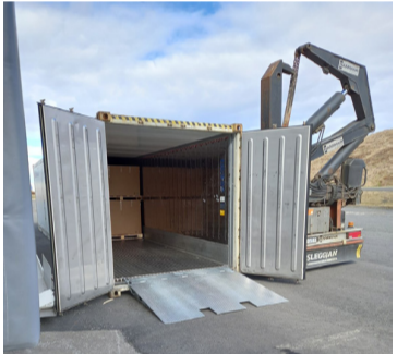
Rampar fyrir frysti/kæligáma á lager. Burðargeta 10 tonn. Dekkplata 10 mm, L- 170 cm x B- 200 cm x hæð- 21 cm. Heitgalvaniserað stál. Lyftaratækur á þrjú vegu. Eignum einnig rampa fyrir hefðbundna sjógáma. Hákonarson ehf. www.hak.is s. 892-4163 hak@hak.is
