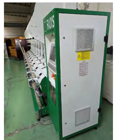
Þetta er nýja vélin sem nýtt er til að færa band frá hönkum yfir í kóna.
