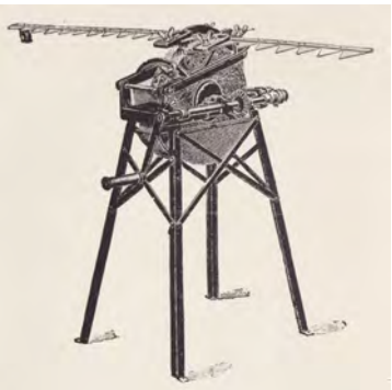
Ljábrynsluvélar komu snemma til sögu og fengust síðan af ýmsum gerðum. Margir létu sér þó nægja að hvetja ljá sláttuvélarinnar með þjöl eða brýni. (Búvélar og ræktun).
