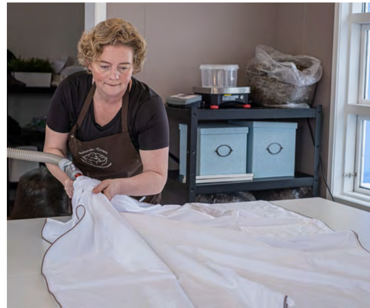
Framleiðslan á sængunum á sér stað í gamla leikskólanum sem ber núna heitið Dúntún. Verin koma forsaumuð erlendis frá og er blásið í hólfín með þar til gerðum vélum.
