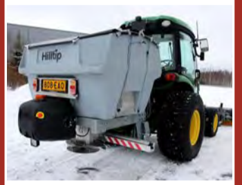
Hilltip Icestriker 600 TR Rafdrifinn kastdreifari fyrir dráttarvélar m/öflugum efnisskómmtunarbúnaði.
