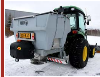
Hilltip Icestriker 600 TR Rafdrifinn kastdreifari fyrir dráttarvélur m/öflugum efnisskömmtarbúnaði.
