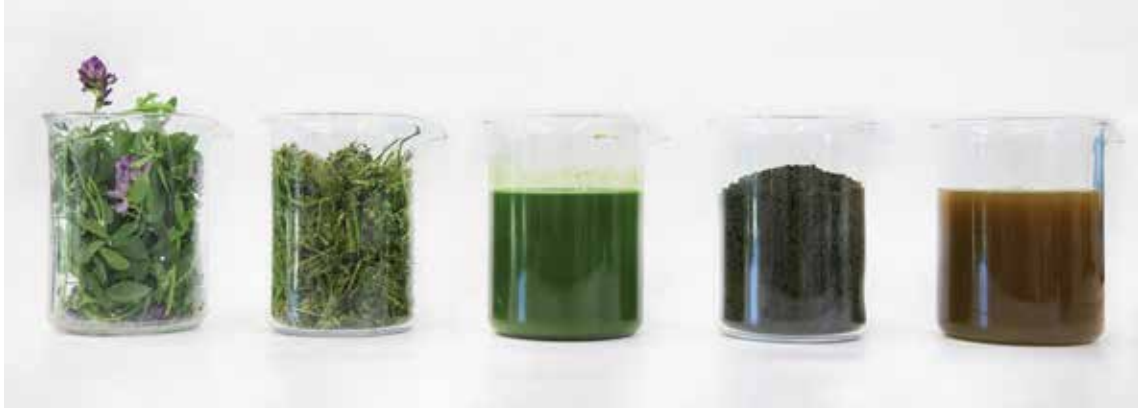
Myndin sýnir upprunalegan efniðvið (refasmára) og afurðir úr vinnslunni sem eru trefjarnar, grænn safi, próteinið, fyrir þurrkun, og brúnn safi.
