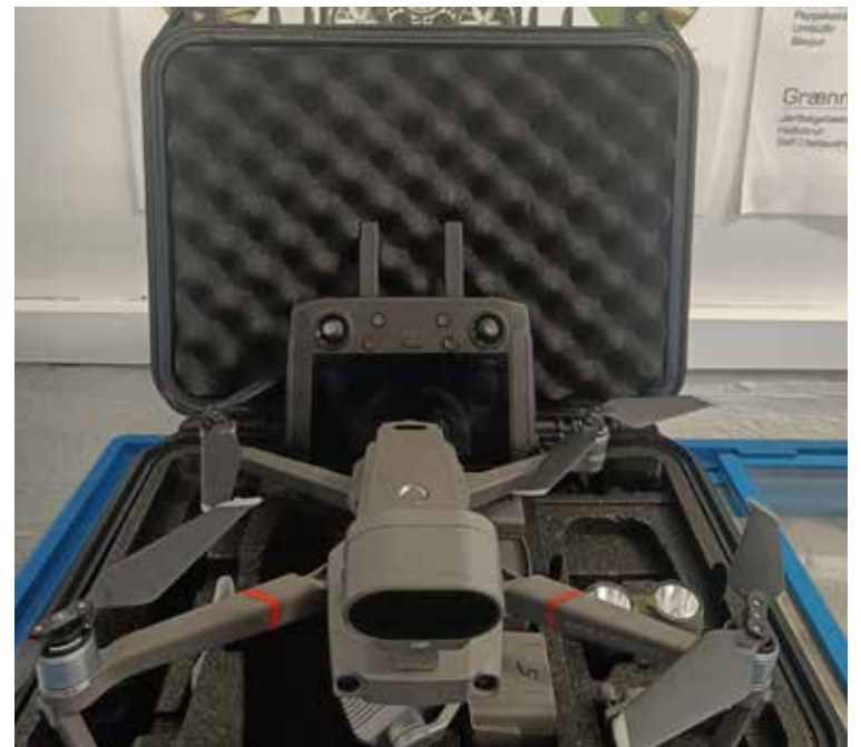
Dróninn sem við notum er DJ Mavic 3 Enterprise sem er með 4k myndavél, ásamt hitamyndavél og hátalara, en einnig er hægt að skipta hátalara út fyrir leitarljós og flugvélaljós.
