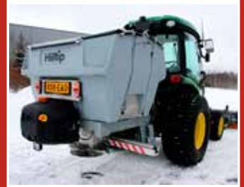
Hilltip Icestriker 600 TR Rafdrifinn kastdreifari fyrir dráttarvélur m/öflugum efnisskömmtunarbúnaði.
