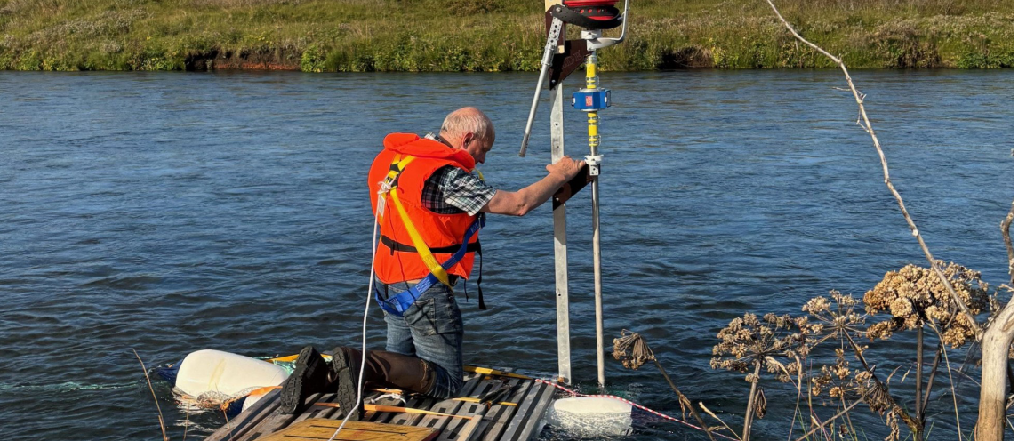
Frá prófunum á nýrri einstrengs-gerð hverfils Valorku ehf. í Brúará á dögunum.
