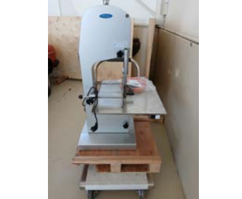
Nett en öflug kjötsög. Auðveld í notkun með kveikju-/slökkvunarhnappi. Hágæða öflugur mótör fyrir stöðuga notkun. Hús úr anodiseruðu áli, búið rúmgóðu borði með kvörðunarplötu og kjötpressu. Spenna sagarblaðsins er stillanleg. Auðvelt að opna og þrifa. Vélin er ný. Upplýsingar gefur G. Hlynur í s. 892-1031.
