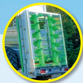
Stórir lóðréttir sniglar, kastspaðar með útsláttaröryggi og HARDOX 450 tennur
