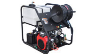
Háprýstibúnaður fyrir stíflulosun í skolp og drenörum. Getum útvegað þennan búnað í mörgum útfærslum og styrkleikum. Fyrir rör frá 30 mm upp í 900 mm. Háprýstislöngur allt að 150 metrar á lengd, 3/8", 1/2", 5/8", 3/4". Bensín / dísil, vatnsflæði allt að: 132 l / min @ 3000 Psi. Búnaður á sér- smíðuðum vagni með þrýstibremsum eða á stálgrind. Búnaðurinn hentar einnig vel fyrir öflugan háprýstipvott. Vandaður og hentugur búnaður fyrir sveitarfélög og verktaka. Hákonarson ehf. Uppl. í síma 892-4163, hak@hak.is , www.hak.is .
