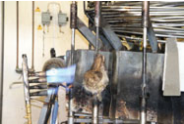
Sviðahausavélin í Smalahovetunet var sérsmiðuð fyrir framleiðsluna og fengu þau lista- og uppfinningamann af svæðinu til að aðstoða sig við smiðina. Hún tekur 15 hausea í einu og er sjö og hálfu mínútu að sviða hvern haus.
