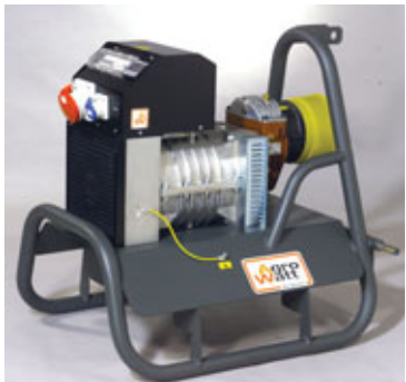
Traktorsdrifnar rafstöðvar (Agro-Watt), www.sogaenergyteam.com - stærðir : 10,8 kw – 72 kw. Stöðvarnar eru með eða án AVR (spennujafnara). AVR tryggir örugga keyrslu á við- kvæmum rafbúnaði t.d mjólkurþjó- um, tölvubúnaði, nýlegum rafsuðum o.fl. Hákonarson ehf. Uppl. í síma 892-4163, hak@hak.is , www.hak.is .
