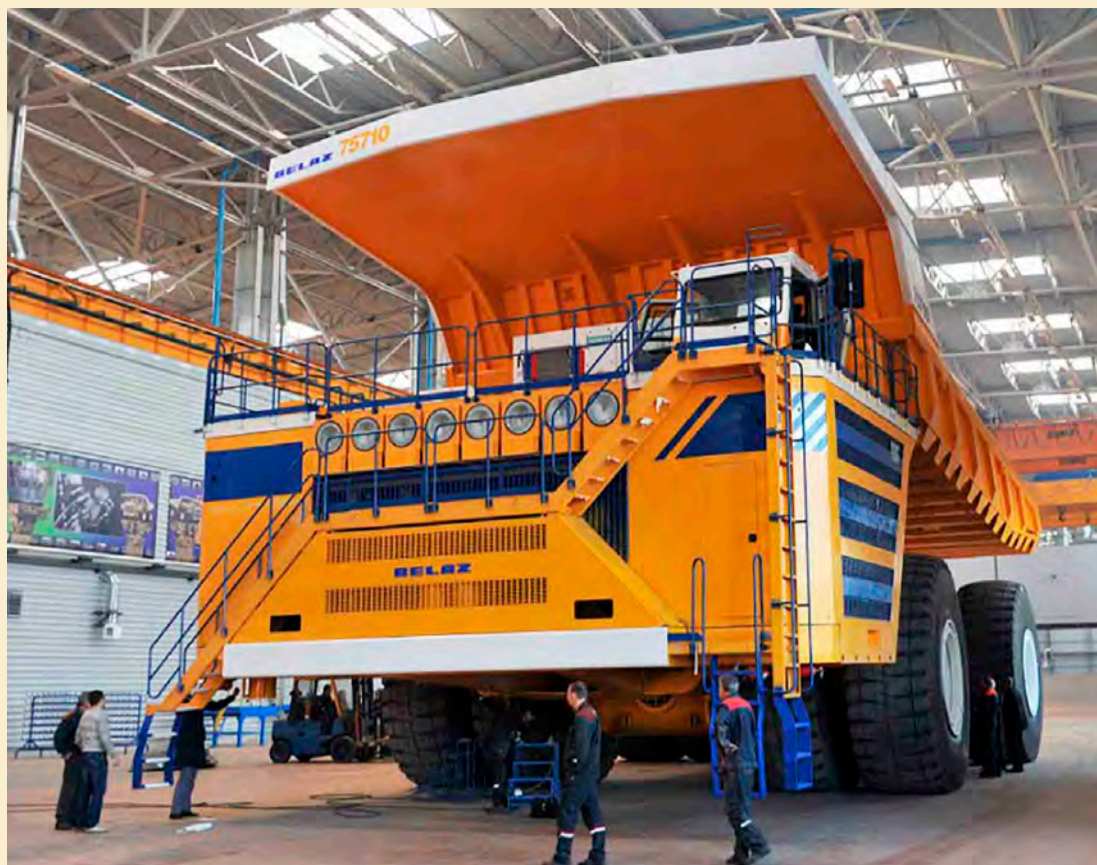
Belaz 75710 er með tvær 2.300 hestafla 16 strokka vélar sem gefa samtals 4.600 hestöfl. Burðargetan er rétt tæp 500 tonn og heildarþyngd með farmi er 856 tonn.
