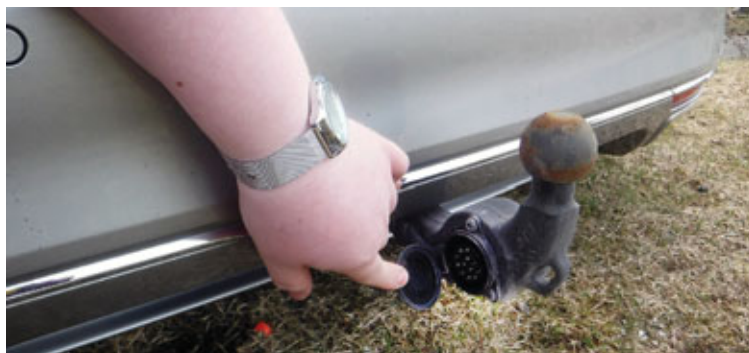
Dráttarkrókurinn læstur, 13 pinna kerfið kallar á að eiga millistykki til að draga flestar kerrur.
