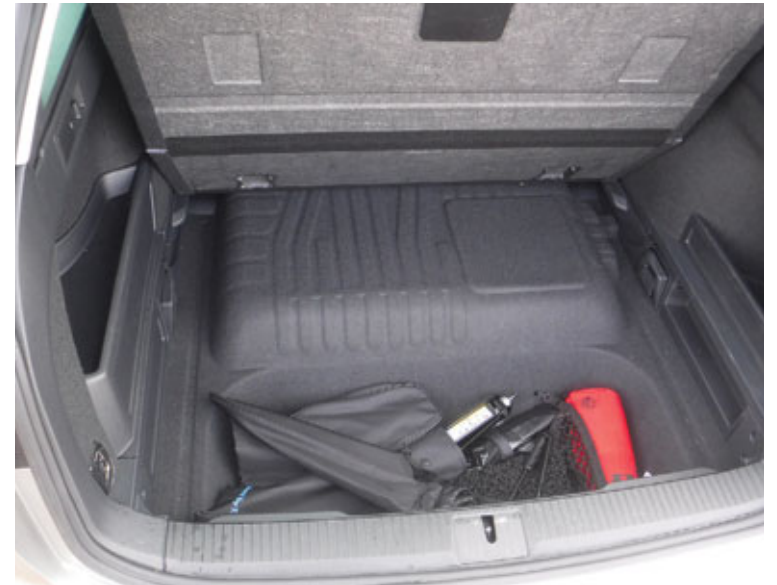
Stór og plássfrek rafhlaðan stelar varadekksplássinu.
