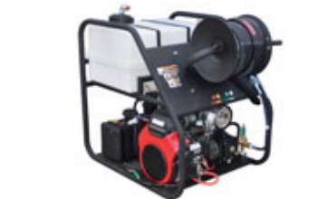
Háprýstibúnaður fyrir stíflulosun í skolp og drenörum. Getum útvegað þennan búnað í mörgum útfærslum og styrkleikum. Fyrir rör frá 30 mm upp í 900 mm. Háprýstislöngur allt að 150 metrar á lengd, 3/8", 1/2", 5/8", 3/4". Bensín / dísil, vatnsflæði allt að: 132 l / min @ 3000 Psi. Búnaður á sér- smíðuðum vagni með þrýstibremsum eða á stálgrind. Búnaðurinn hentar einnig vel fyrir öflugan háprýstipvott. Vandaður og hentugur búnaður fyrir sveitarfélög og verkta. Hákonarson ehf. Uppl. í síma 892-4163, hak@hak. is, www.hak.is.
