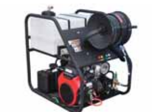
Háprýstibúnaður fyrir stíflulosun í skolp og drenörum. Getum útvegað þennan búnað í mörgum útfærslum og styrkleikum. Fyrir rör frá 30 mm upp í 900 mm. Háprýstislöngur allt að 150 metrar á lengd, 3/8", 1/2", 5/8", 3/4". Bensín / dísil, vatnsflæði allt að:132 l / min @ 3000 Psi. Búnaður á sér- smíðuðum vagni með þrýstibremsum eða á stálgrind. Búnaðurinn hentar einnig vel fyrir öflugan háprýstipvott. Vandaður og hentugur búnaður fyrir sveitafélög og verktaka. Hákonarson ehf. Uppl. í síma 892-4163, hak@hak. is, www.hak.is.
