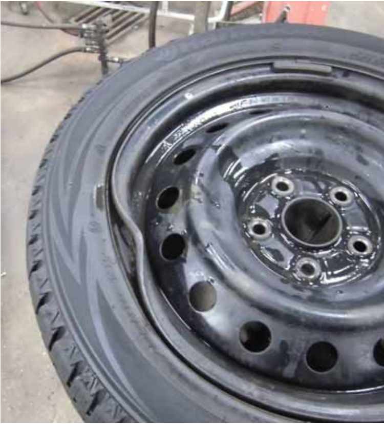
Önýtt felga og marið dekk eftir viðureign við brotholu í illa skemmdu malbiki.
