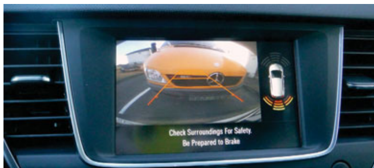
Bakkmyndavélin sýnir vel aftur og er með línur sem áætluð bakkleið er sýnd.
