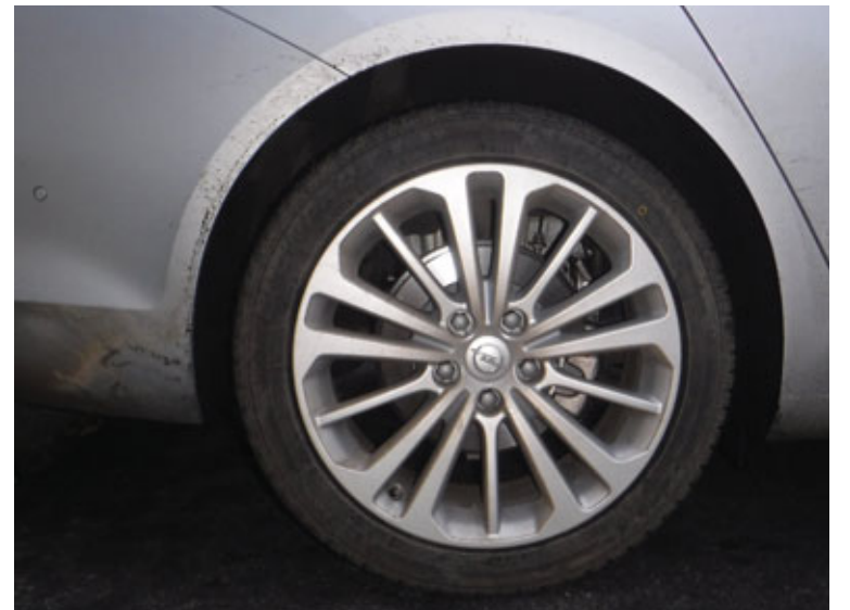
Dekk með svona lágan prófil gefa nánast enga fjöðrun á holóttum malarvegum.
