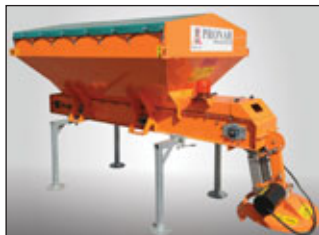
Salt- og sanddreifari Pronar, EPT15 1,5 m3, rafstýrður, 12V Verð 1.190.000 án vsk.
