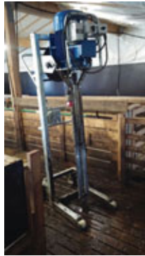
Innihræður fyrir gripahús. Rafdrifnar: 7,5 kW, 9,2 kW, 11 kW, glussadrifnar: 8 kW, 60 l / mín., 120 bar. Vinnudýpt: 130 cm, skrúfa: 200 mm. Hákonarson ehf. Uppl. í s. 892-4163, hak@hak. is, www.hak.is.
