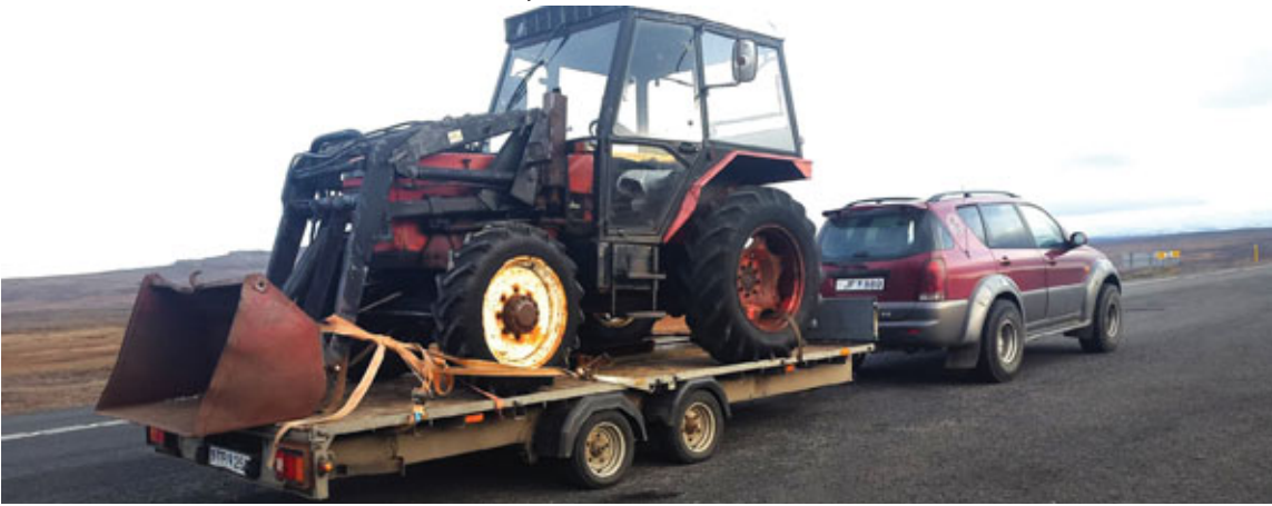
Samanlagður þungi kerru og vélarinnar er langt yfir leyfilegri þyngd dráttargetu jeppans og 50 mm dráttarkúlunnar. Sektin við þessu er mjög há þar sem að yfirþungi til sektar reiknast í prósentum (hámarkssekt við of miklum þunga er í milljónum talið).
