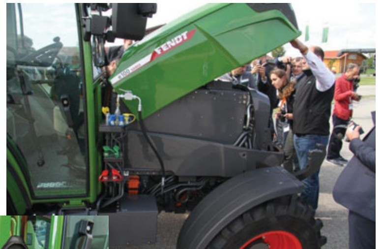
Það er dálítið örðuvísi um að litast undir húddinu á rafmagnsdráttarvéllum en hefðbundnum dísilknúnum véllum.
