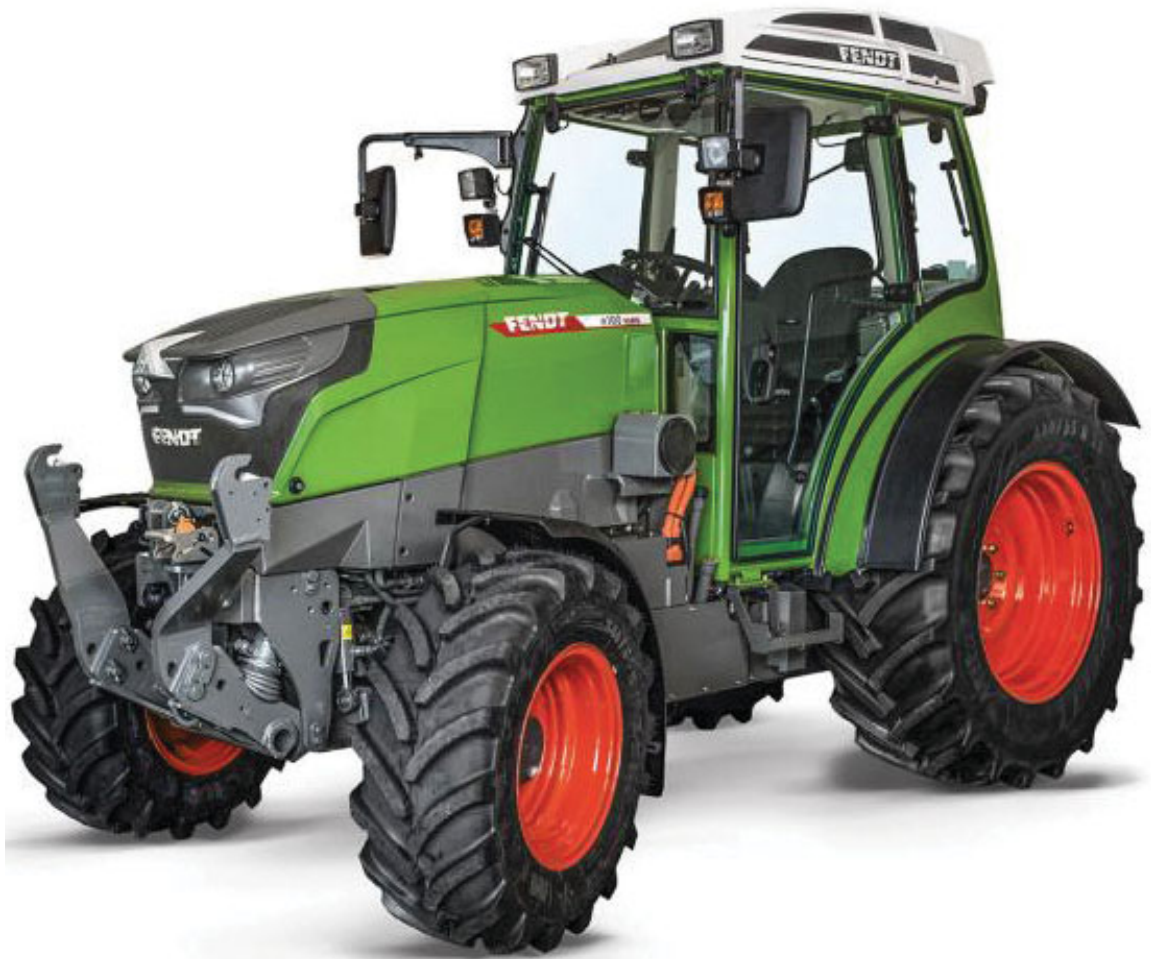
Fendt E100 Vario vélin sem sögð er koma á markað á næsta ári verður með 22 kílówatta rafmótör, eða sem svarar 65 hestafla vél.
