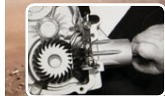
Pinnjon og kambur eru sérstök að því leyti að tannhjól eru jafn stór og þola því meira átak.
