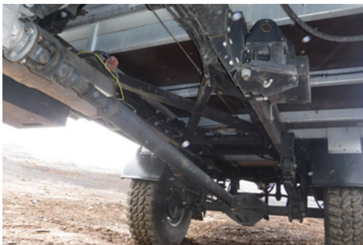
Bæði fram- og afturdrifsköft eru tveggja hjöruliða.
