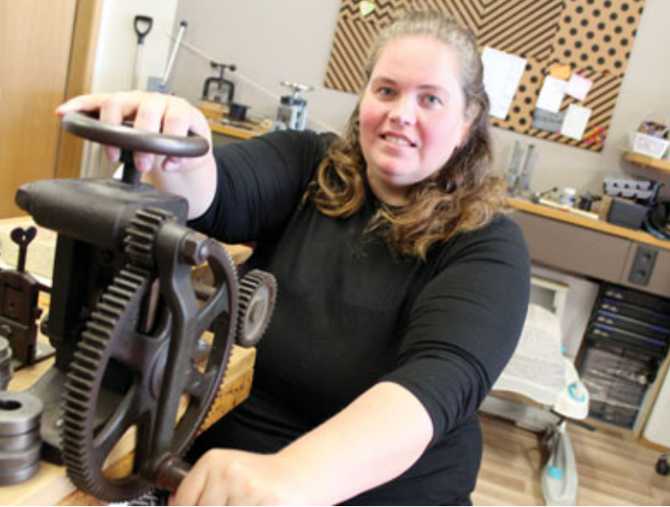
Júlía keypt gamalt gullsmíðaverkstæði frá Siglufirði og var þessi góða græja með í kaupunum, algjör gullmoli segir hún, en tækið notar hún til að gera virinn sem notaður er inn í víravirkið.
