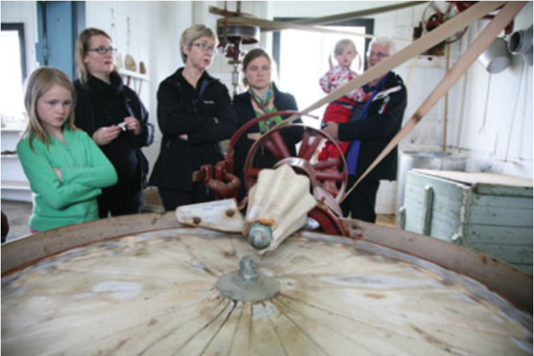
Úr vélasal Rjómabúsins á Baugsstöðum. Fremst er hnoðunarborðið en fyrir aftan það er smjörstrokurinn. Lengst til hægri er ostaker.
