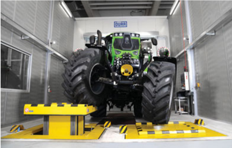
Eftir sprautun er hjólabúnaður dráttarvélna þolprófaður áður en þær eru sendar úr húsi. Mynd / Deutz-Fahr.
