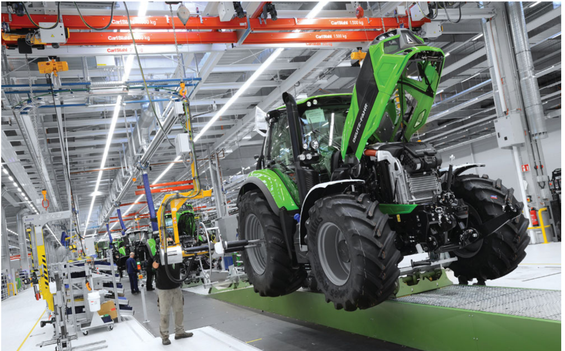
Samsetning dráttarvélanna fer fram á færíbandi og til að spara starfsmönnum við færíbandið sporin standa þeir einnig á færíbandi við samsetninguna.
