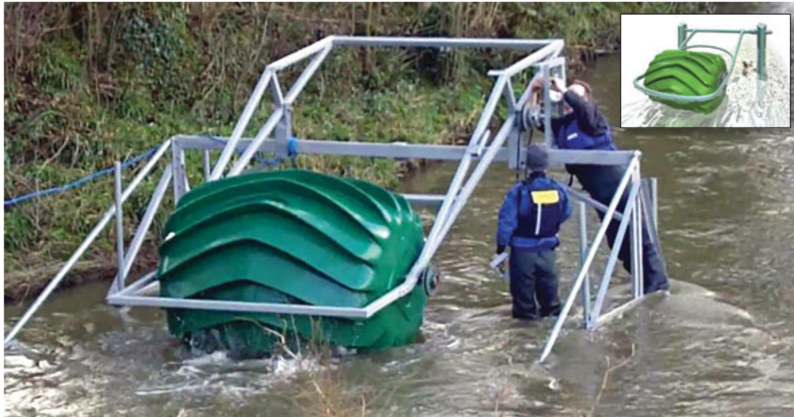
Hægstraums-rennslisvirkjanir geta verið af ýmsum toga og útheimta engar stíflur. Í þessari snjöllu hugmynd sjá flöteiginleikar tromlunnar um að fylgja eftir breytilegri stöðu á vatnsyfirborðinu. Slíkar rennslisvirkjanir verða þó trúlega aldrei sérlega afkastamiklar. Þær munu því varla duga til að tvöfalda raforkuframleiðsluna á Íslandi fyrir árið 2050.
