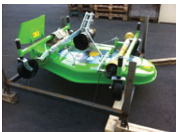
Nýr sláttubúnaður frá Peruzzo með drifskafi. Með 3 hnífum sem snúast í láréttum fleti, 150 cm sláttubreidd. Sterkbyggt og afkastamikið sláttutæki! Uppl. í síma 896-4494.
