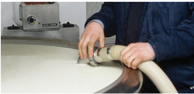
Hér má nefna atriði eins og að mæla loftblöndun inn í mjólkina og skoða hvort einhvers staðar séu t.d. loftlekar eða bilaðar dælur sem geta piskað mjólkina á leið hennar frá spenaendanum út í mjólkurtank.
