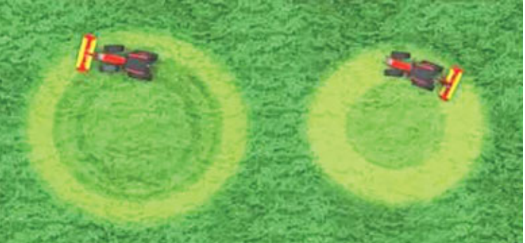
Það er sameiginlegt með öllum vélum að aflúttak er mun sterkara að aftan og afturlýftur mun öflugri. Þreskivélar eru dæmi um tæki sem hafa beygjur að aftan til að minnka vinnutap í beygjum. Beygjur að aftan gefa mun minni beygjuráðis á sláttuvélinni og afturdekkinn elta sláttugárann.
