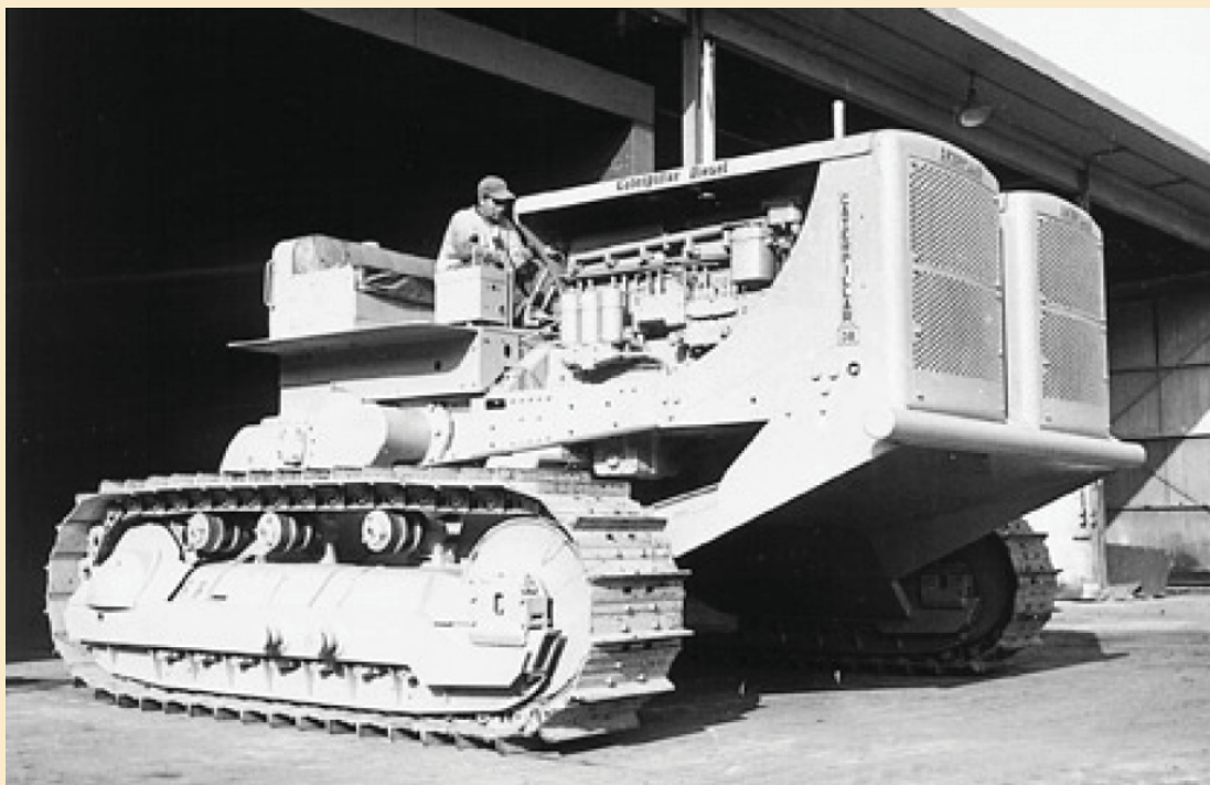
Ein af þremur Caterpillar Twin D8 síamstvíburavélum sem smíðaðar voru af Peterson Caterpillar í Kaliforníu árið 1949 og síðar.
