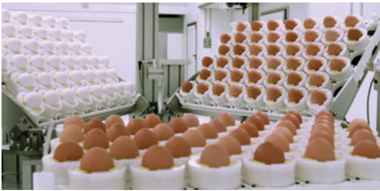
Greining hænsnfugla í kyn í eggjum tekur innan við sekúndu fyrir hvert egg.
