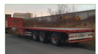
Pacton flatvagn 13 m flatvagn fyrir 10 hjóla bíl. Búkki á fyrsta öxli, aftasta hásing stýranleg. Verð: 1.500.000 + vsk.
