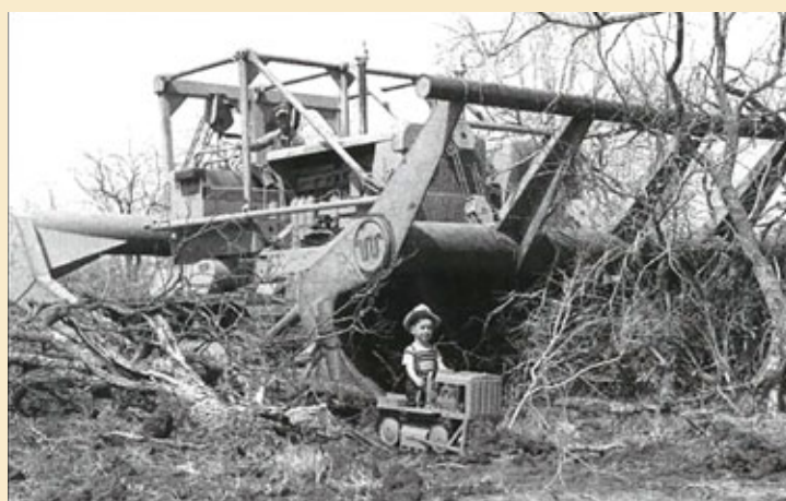
Þriðja síamsvélin af Caterpillar D8 var smíðuð fyrir King Ranch í Texas. Hún var útbúin Holt Funnel trjáruðningsplóg. Hér er hún og líklega er það sonur ýtustjórans sem hér sést stoltur í forgrunni á sinni leikfangaytu.
