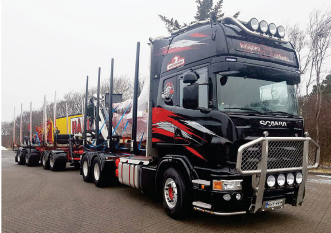
Nýi timburflutningabíllinn er Scania R 620 topliner Palfinger Epsilon Q150L97 með krana með húsi aftan á hleðslupalli sem hleður jöfnum höndum á bíl og tengivagn.
