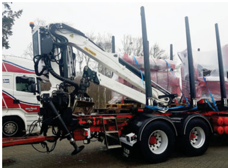
Nýi timburflutningabíllinn er Scania R 620 topliner Palfinger Epsilon Q150L97 með krana með húsi aftan á hleðslupalli sem hleður jöfnum höndum á bíl og tengivagn.
