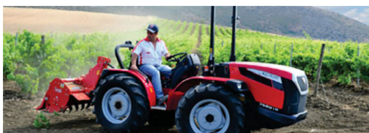
Valpadana er sérhæfð vínekrutraktarvél sem nýtist vel við skógarvinnsluna þegar glíma þarf við mikinn hliðarhalla.
