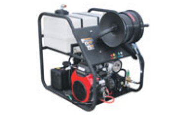
Háprýstibúnaður fyrir stíflulosun í skolp og drenörum. Getum útvegað þennan búnað í mörgum útfærslum og styrkleikum. Fyrir rör frá 30 mm upp í 900 mm. Háprýstislöngur allt að 150 metrar á lengd, 3/8", 1/2", 5/8", 3/4". Bensín / dísil, vatnsflæði allt að: 132 l / min @ 3000 Psi. Búnaður á sérsmíðuðum vagni með þrýstibremsum eða á stálgrind. Búnaðurinn hentar einnig vel fyrir öflugan háprýstipvott. Vandaður og hentugur búnaður fyrir sveitafélög og verktaka. Hákonarson ehf. Uppl. í síma 892-4163, hak@hak.is, www.hak.is.
