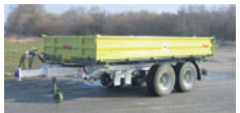
Fliegl TDK 110-88 pallur, er 450x222cm. Galvaníseruð grind. Sturtur á þrjá vegu, öll ljós eru á henni til skráningar, breið burðardekk 355/60 R18 16 PR. Verð 2.400.000 + vsk.
