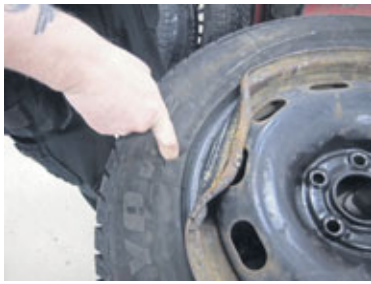
Þessari felgu var hægt að bjarga, en dekkið var ónytt.
