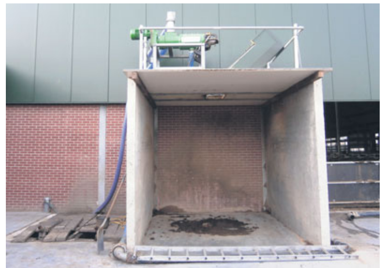
Búnaðurinn sem er notaður til þess að vinna taðtrefjar úr mykjinni er frekar einfaldur eins og sjá má
