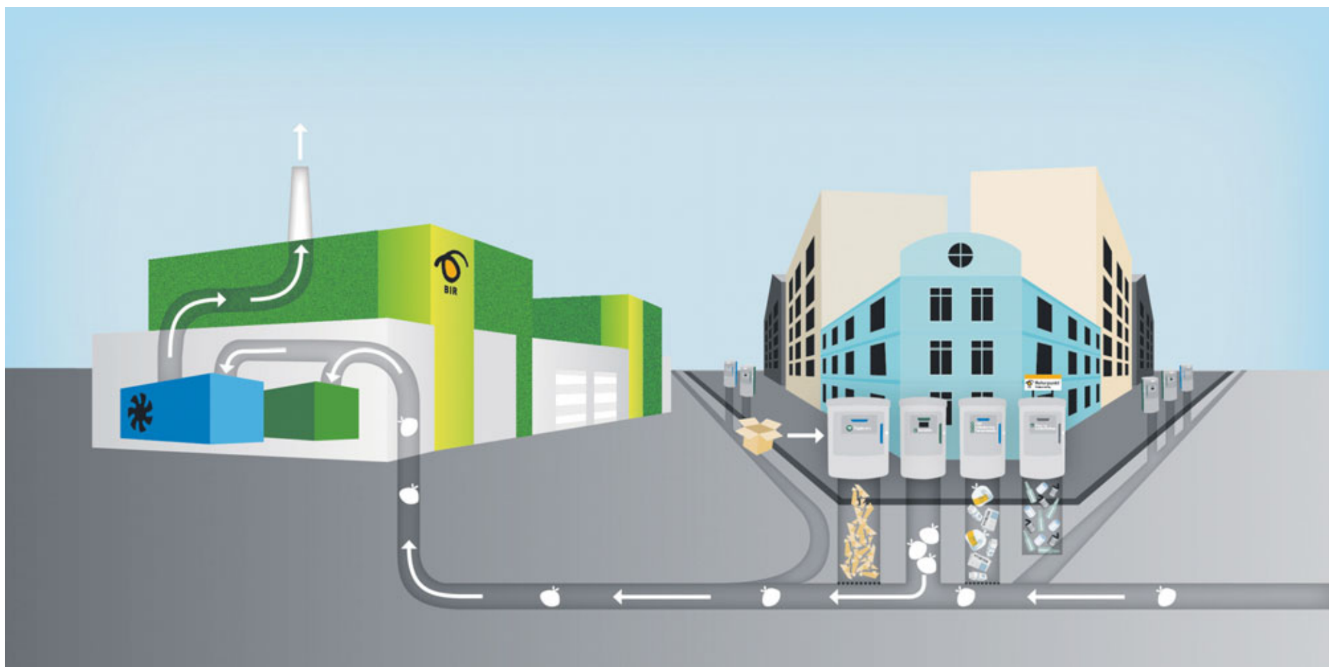
Yfirlitsmynd af nýja ruslakerfinu í miðbæ Björgvinjar þar sem ruslið sogast með loftstraumi í þar til gerðum rörum neðanjarðar og yfir í gáma í flokkunarstöð.
