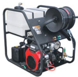
Háprýstibúnaður fyrir stíflulósun í skolp og drenrörum. Getum útvegað þennan búnað í mörgum útfærslum og styrkleikum. Fyrir rör frá 30 mm upp í 900 mm. Háprýstilöngur allt að 150 metrar á lengd, 3/8", 1/2", 5/8", 3/4". Bensín / dísil, vatnslæði allt að: 132 L / min @ 3000 Psi. Búnaður á sérsmíðuðum vagni með þrýstibremsum eða á stálgrind. Búnaðurinn hentar einnig vel fyrir öflugan háprýstipvott. Vandaður og hentugur búnaður, fyrir sveitafélög og verkta. Hákonarson ehf. Uppl. í síma 892-4163, hak@hak.is, www.hak.is.
