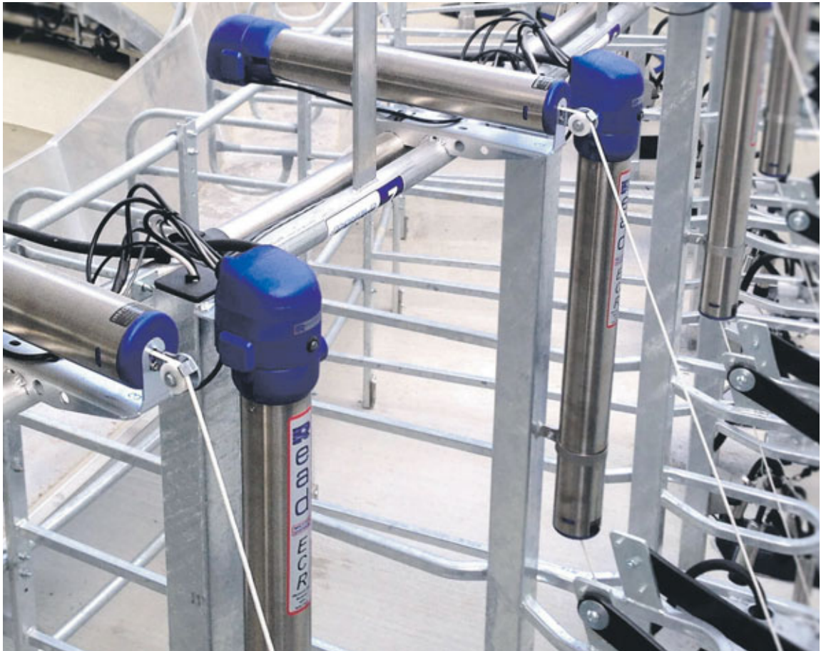
Sjálfvirkir aftakarar fyrir mjaltatæki hafa nú verið til í hálfra öld og fást í dag ótal mismunandi útfærslur af þessum mikilvæga þarfa þjóni kúabænda.
