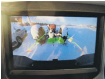
Augað fyrir bakkmyndavélina er staðsett þannig að maður sér dráttarkúluna þegar hún er á bílnum þannig að auðvelt er að bakka að kerru eftir myndavélinni.
