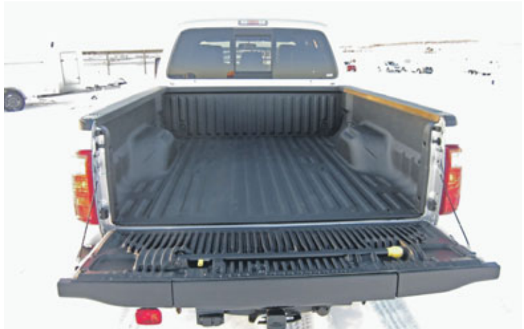
Pallurinn á prufubílnum var heithúðaður, eitthvað sem allir ættu að láta gera við nýja pallbíla.
