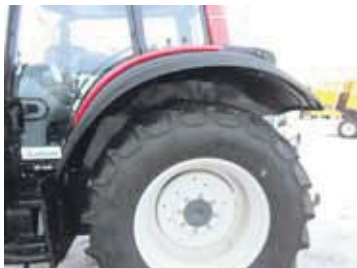
Mikið pláss á milli dekkja og bretta auðveldar ef þarf að keðja vélina.
