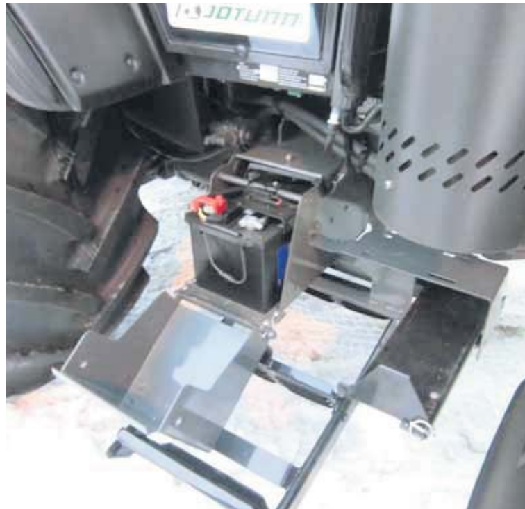
Auðvelt er að komast að rafgeyminum, eitt splitti og stiginn dettur.
