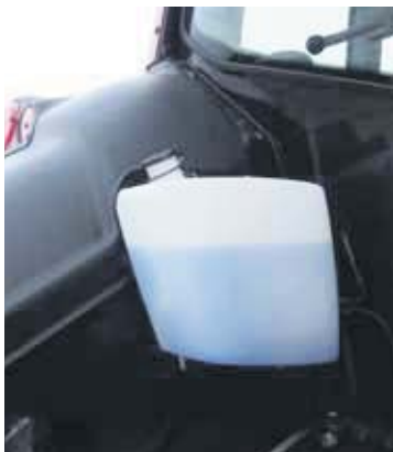
Rúðupisstankurinn er hafður utan á vélinni til að auðvelda aðgengi.
