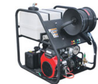
Háprýstibúnaður fyrir stíflulösun í skolp og drenörum. Getum útvegað þennan búnað í mörgum útfærslum og styrkleikum. Fyrir rör frá 30 mm upp í 900 mm. Háprýstislöngur allt að 150 metrar á lengd, 3/8", 1/2", 5/8", 3/4". Bensín / dísil, vatnsflæði allt að 132 l / min @ 3000 Psi. Búnaður á sér- smíðuðum vagni með þrýstibremsum eða á stálgrind. Búnaðurinn hentar einnig vel fyrir öflugan háprýstipvott. Vandaður og hentugur búnaður fyrir sveitafélög og verktaka. Hákonarson ehf. Uppl. í síma 892-4163, hak@hak. is, www.hak.is.
