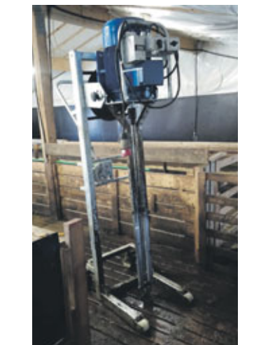
Innihærur fyrir gripahús. Rafdrifnar : 7,5 kw, 9,2 kw, 11 kw glussadrifnar : 8 kw, 60 l / min., 120 bar. Vinnudýpt : 130 cm skrífa : 200 mm. Hákonarson ehf. Uppl. í síma 892-4163, hak@hak. is, www.hak.is.
