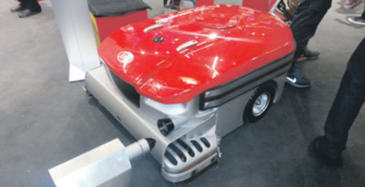
Skítasugan frá Lely. Hollenska fyrirtækið Lely kynnti á sýningunni nýja gerð af flórgoða, en þessi er frábrugðin öðrum slíkum á markaðinum þar sem hún safnar saman mykjunni og losar á þar til gerðan stað. Fyrir vikið er hægt að nota þennan flórgoða, sem nefnist Lely Discovery 120, í fjósum með heil gólf en hingað til hafa flórgoðar fyrst og fremst hentað í fjósum með steinbitum.
