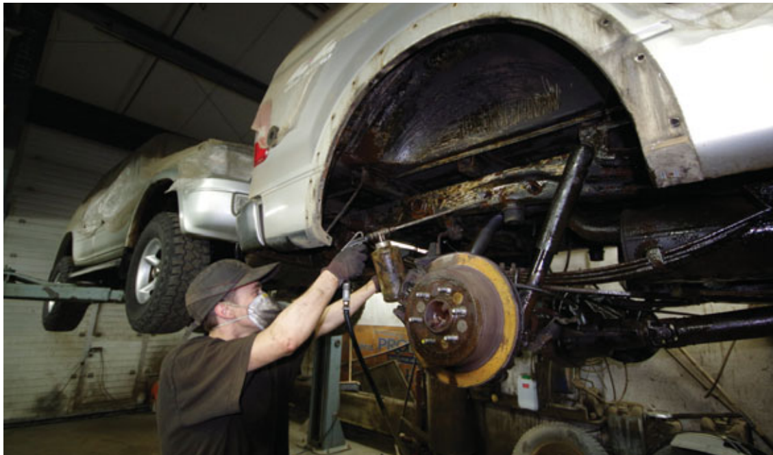
Starfsmaður Smára að sprauta Prolan-efni inn í burðarvirki á nokkurra ára gömlum bíl. Eins og sést er búið að fjarlægja hlífar og meira að segja brettakanta til að komast að öllum holrúmunum.
