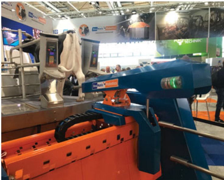
Frumutelarinn frá GEA vann heiðursverðlaun á EuroTier í ár en um er að ræða tæki sem getur í rauntíma talið frumur í mjólk frá hverjum júgurhluta.
