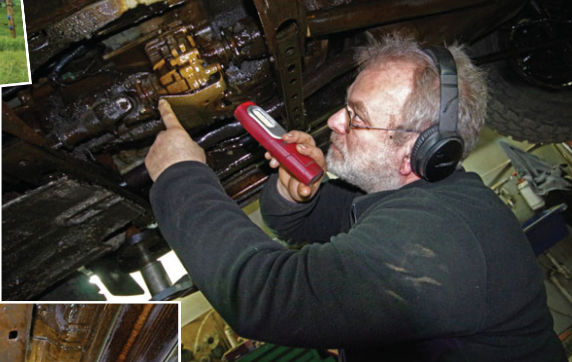
Smári bendir á drifbúnað og ýmis holrúm undir bílnum sem passað er upp á að verði ekki út undan þegar Prolan-efninu er sprautað á undirvagninn.
